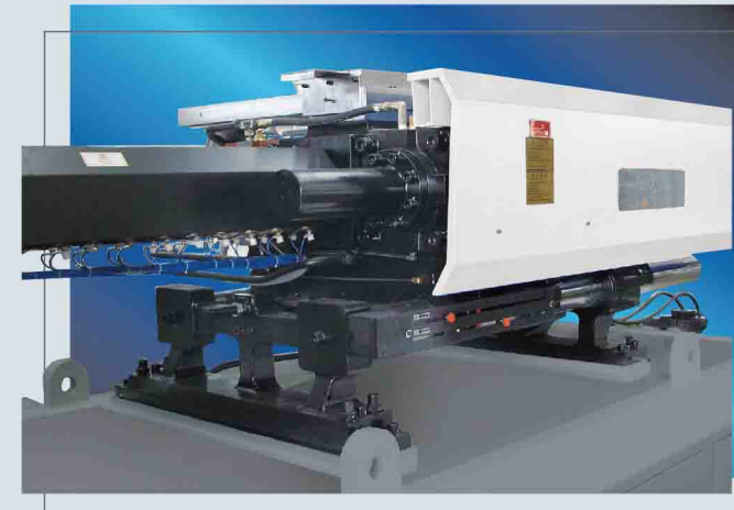
新式射移結構 New Injection Sliding Structure
